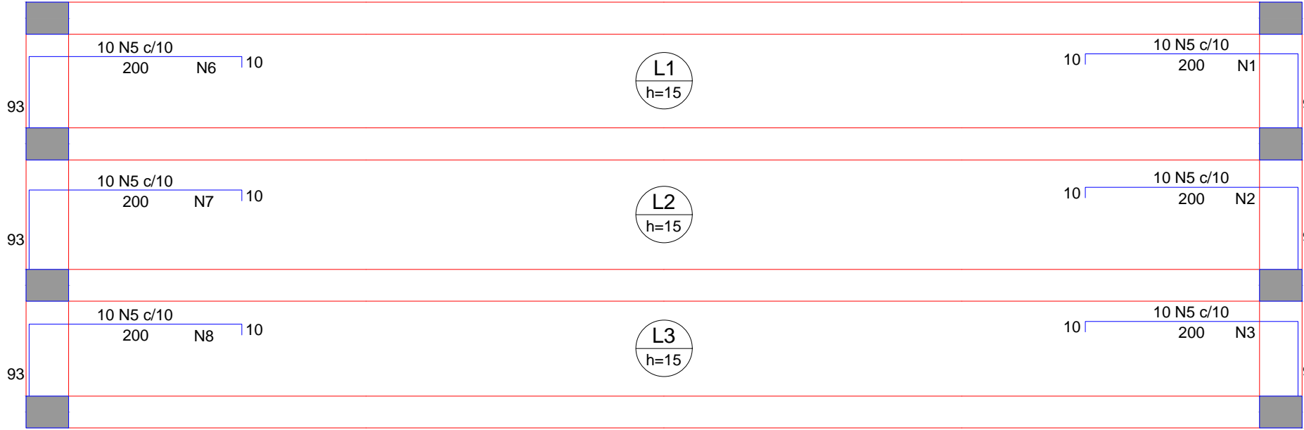
Armação negativa das lajes do pavimento Cobertura (Eixo X) escala 1:50
